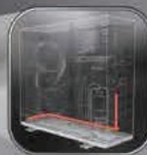
Le conduit de liquide réchauffe le serpentin inférieur en tout temps pour un fonctionnement fiable lors de conditions hivernales extrêmes
