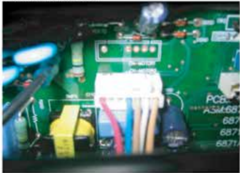
Fan motor connections
