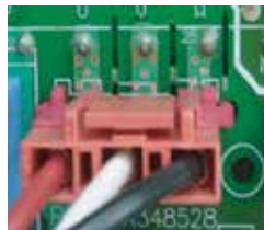
Fan Motor Wire Connections.
