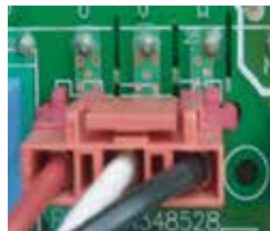
Fan Motor Wire Connections.
