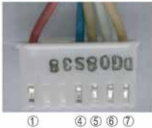
Fan motor connections
